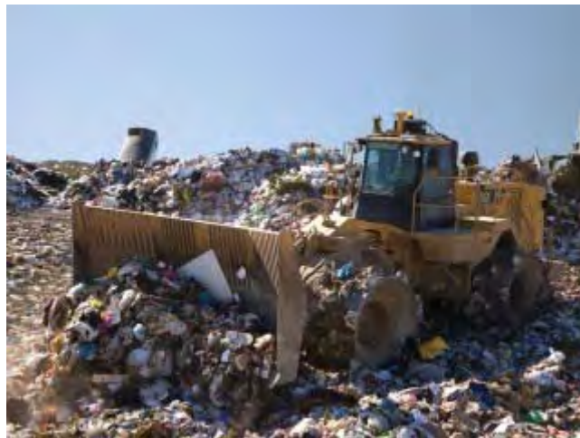
Слика 34. Приказ рада компактора на депонији
