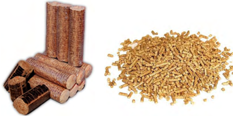
Слика 46. Изглед брикета (лево) и пелета (десно) од пресоване биомасе
