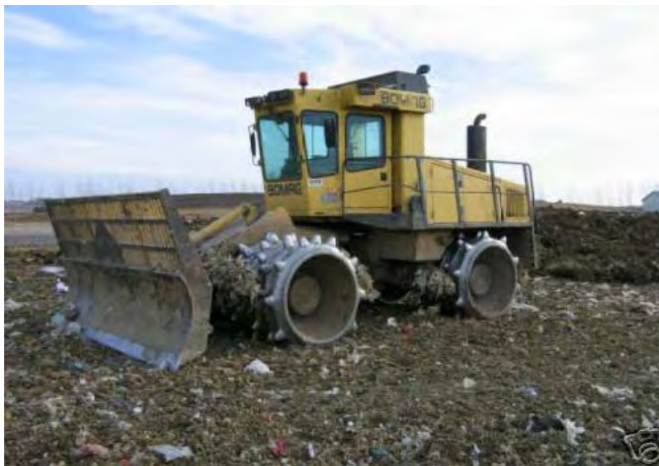
Слика 69 - Приказ рада булдожера компактора на депонији
