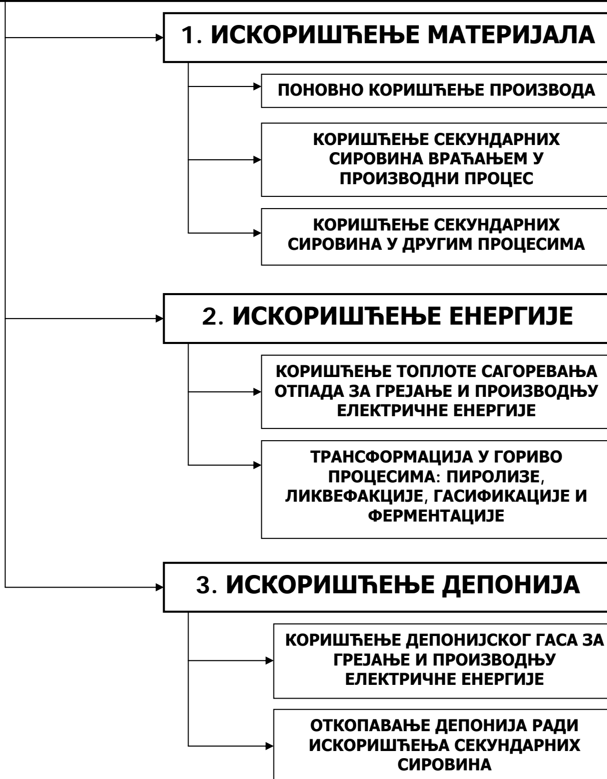
Слика 2. - Могућности прераде отпада уз искоришћење енергије и сировина
