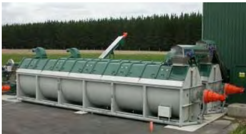
Слика 45. Изглед хоризонталног реактора
